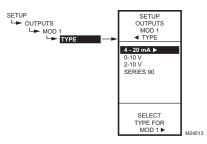
Fig. 47. Setup - Outputs - Mod Out - Type.
